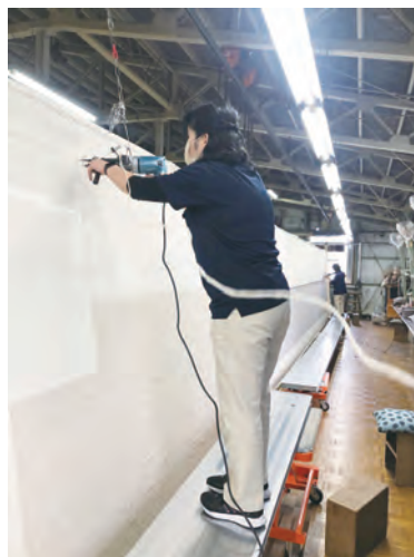
フックガンを使って基布にパイルを打ち付け
